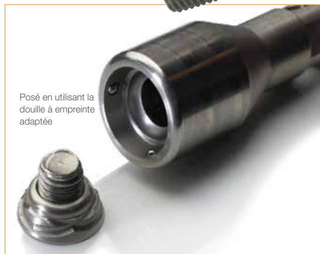
Posé en utilisant la douille à empreinte adaptée
